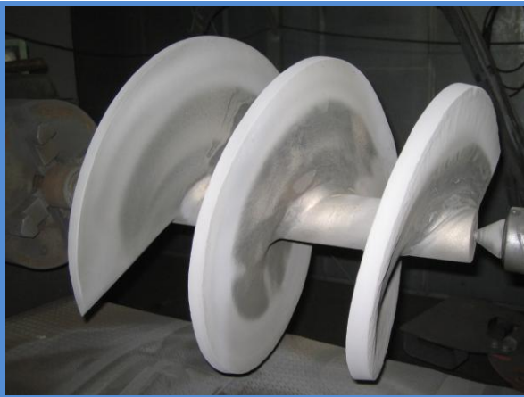
Proyección térmica de Carburo de Tungsteno Cobalto Cromo mediante HVOF
