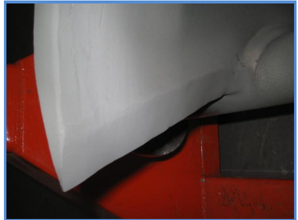
Proyección térmica de Carburo de Tungsteno Cobalto Cromo mediante HVOF
