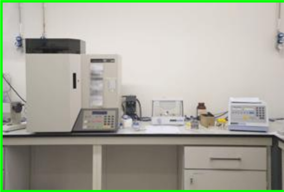
Perkin Elmer 2400 Poca cantidad de muestra (<1 mg) Análisis C, N, H
